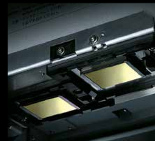
Печатающие головки, расположенные в шахматном порядке
