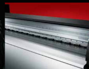
Новая система подачи включает 16 прижимных валиков: даже на больших тиражах безупречно воспроизведены все детали вплоть до отдельных букв
