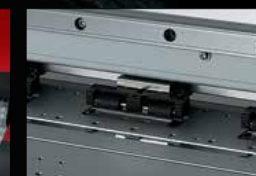
Новая система подачи включает 16 прижимных валиков: даже на больших тиражах безупречно воспроизведены все детали вплоть до отдельных букв
