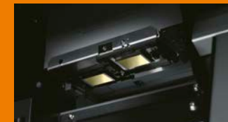
Две печатающих головки в шахматном порядке
